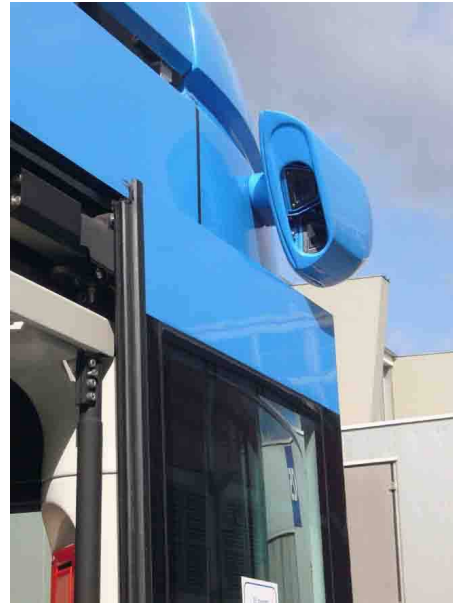
Außenkameras zur Fahrerunterstützung an der Crotram der Firma KONCAR External cameras for driver assistance at Crotram of KONCAR
