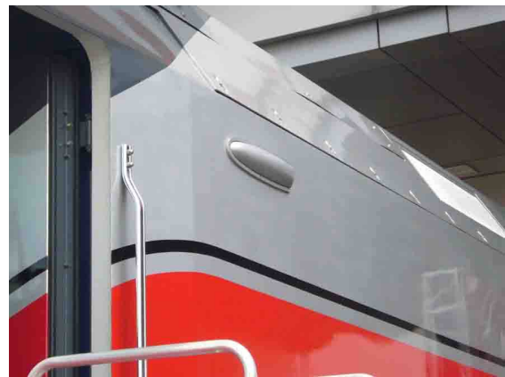
Außenkameras zur Fahrerunterstützung an einer TALGO Lokomotive External cameras for driver assistance at a TALGO locomotive
